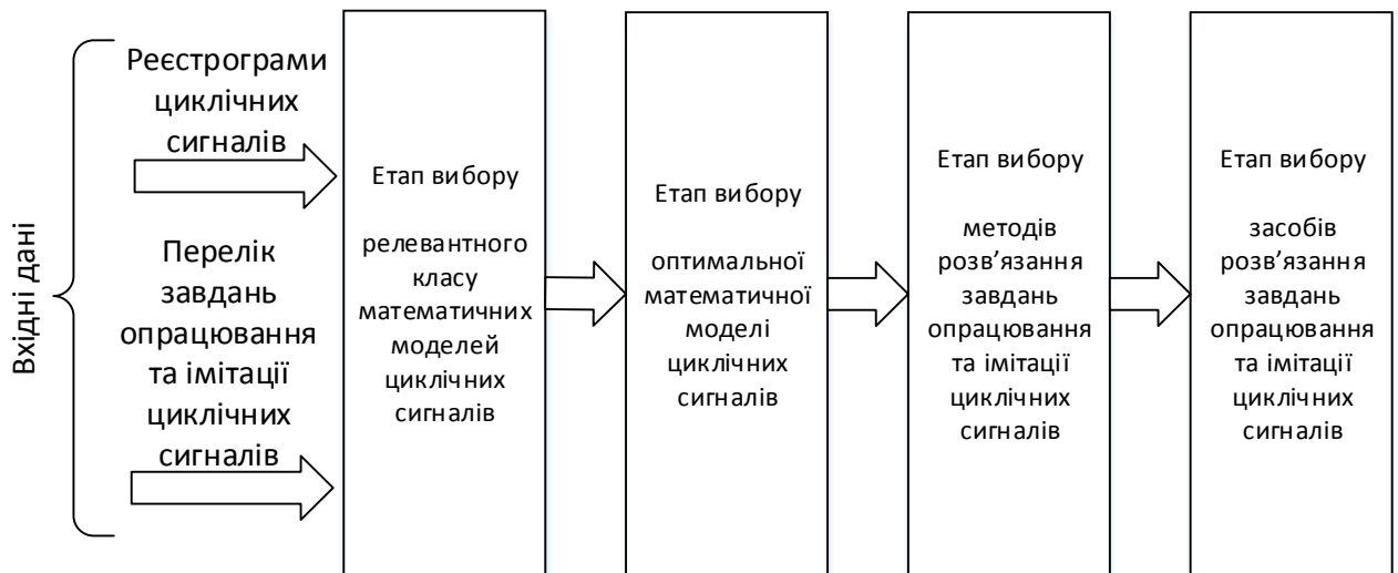
Рисунок 4.5. Основні етапи функціонування EOC_MOQC підтримки прийняття рішень у галузі моделювання, опрацювання та комп'ютерної симуляції циклічних сигналів
